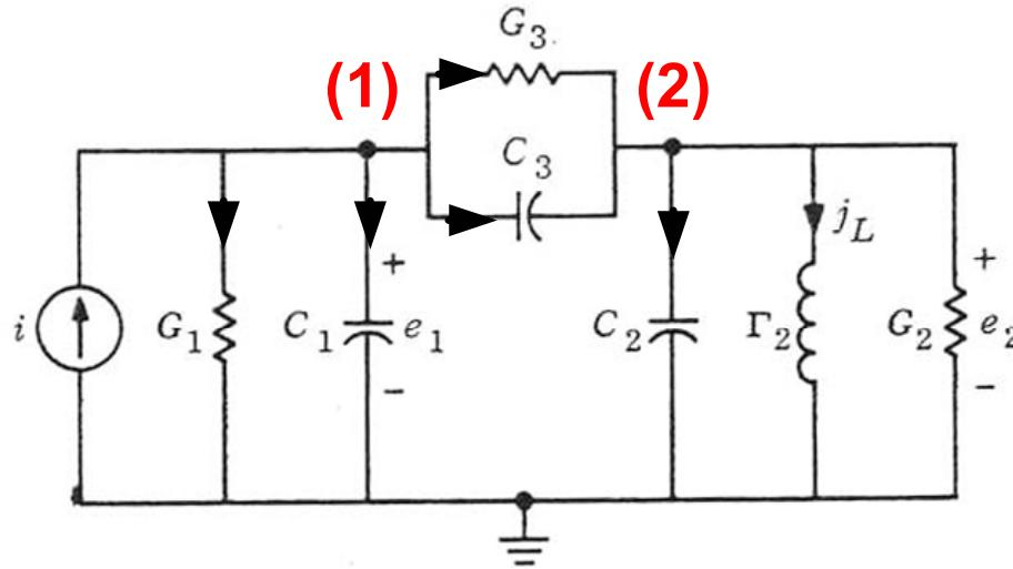
**Node (2)** w/ KCL :  $-j_{C_3} - j_{G_3} + j_{C_2} + j_{\Gamma_2} + j_{G_2} = 0$
