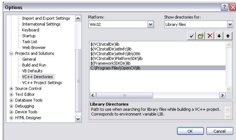
รูปที่ 3 เลือก Open CV ของ Directories library files
